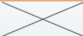
6. **Горизонтальная связь** — элемент конструкции служит для придания жесткости и ограждением в местах подъема на леса, также могут использоваться для ограждения рабочей зоны.
